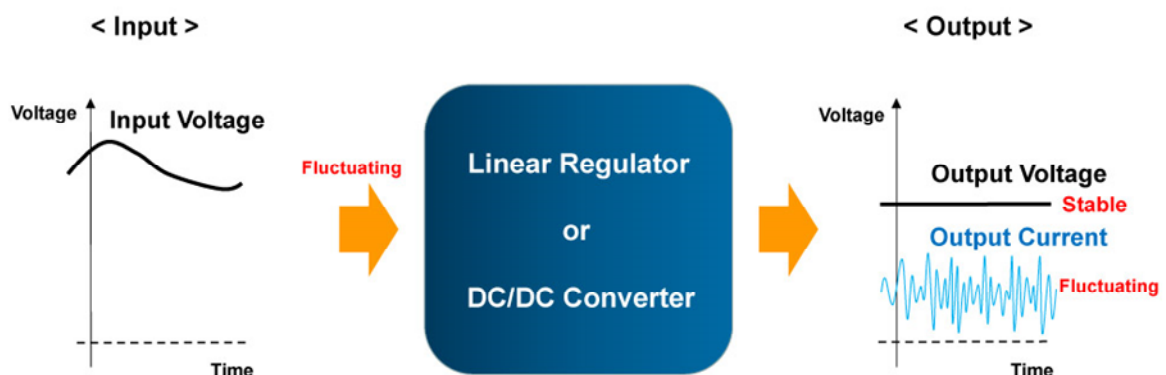
Abbildung 4. Funktionsweise von Reglern
